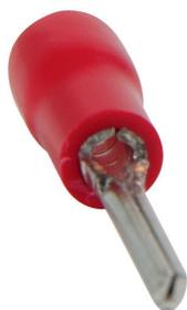
Наконечники штыревые круглые НШКИ обеспечивают оконцевание проводов и кабелей с медными жилами сечением от 0,5 до 6,0 мм<sup>2</sup> в электрических цепях переменного и постоянного тока напряжением до 400 В. Применяются для крепежа наконечников к клеммам электрического оборудования.
