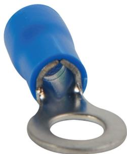
Наконечники кольцевые обеспечивают окончание проводов и кабелей с медными жилами сечением от 0,5 до 6,0 мм<sup>2</sup> в электрических цепях переменного и постоянного тока напряжением до 400 В на основе винтовой фиксации. Применяются на подвижных или подверженных вибрациям контактах!
