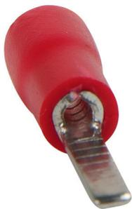
Наконечники штыревые плоские НШПИ обеспечивают оконцевание проводов и кабелей с медными жилами сечением от 0,5 до 6,0 мм<sup>2</sup> в электрических цепях переменного и постоянного тока напряжением до 400 В. Применяются для крепежа наконечников к клеммам электрического оборудования.
