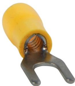
Наконечники вилочный НВИ обеспечивают оконцевание проводов и кабелей с медными жилами сечением от 0,5 до 6,0 мм<sup>2</sup> в электрических цепях переменного и постоянного тока напряжением до 400 В на основе винтовой фиксации.
